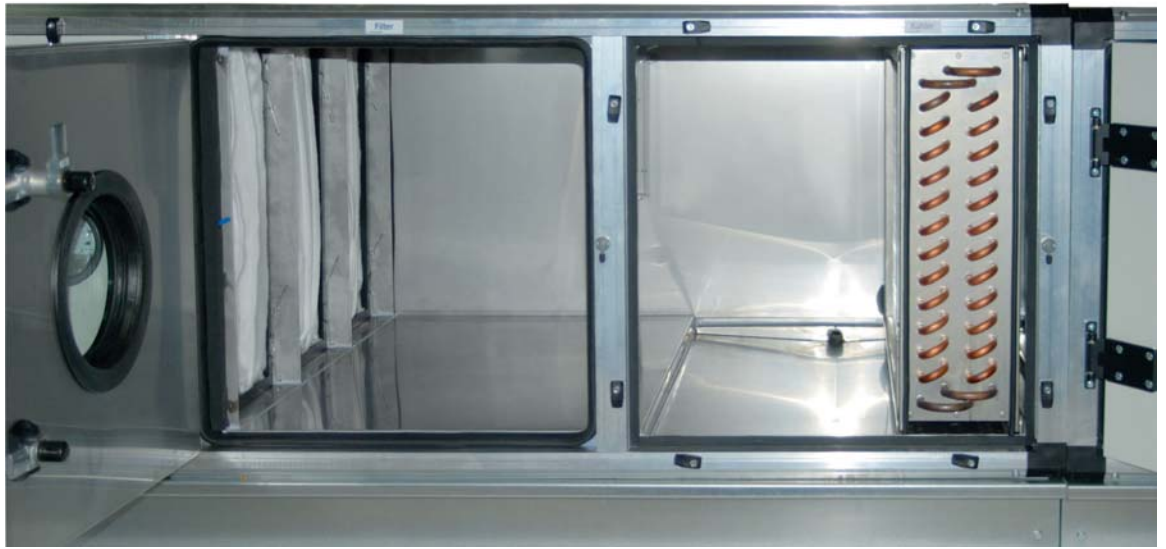
Abbildung 2: Bei hochwertigen Hygiene-RLT-Geräten müssen gemäß DIN 1946 Teil 4 zumindest die Geräteböden komplett in Edelstahl ausgeführt werden. (Abb. © Howatherm GmbH)
